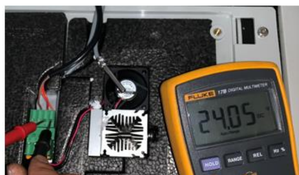
右边2个端子为风扇的供电DC24V。
