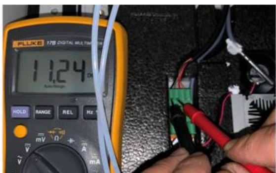
■ 左边2个端子为冷却模块的供电 DC11V
