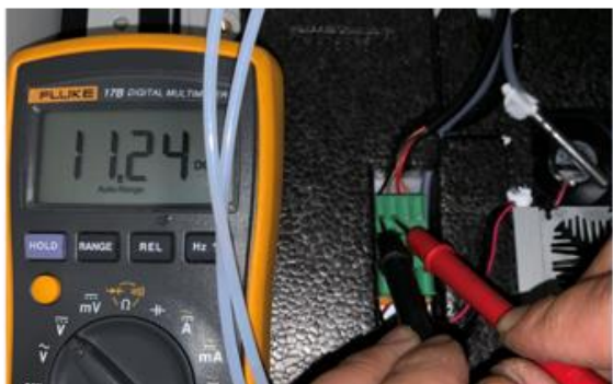
■ 左边2个端子为冷却模块的供电 DC11V
