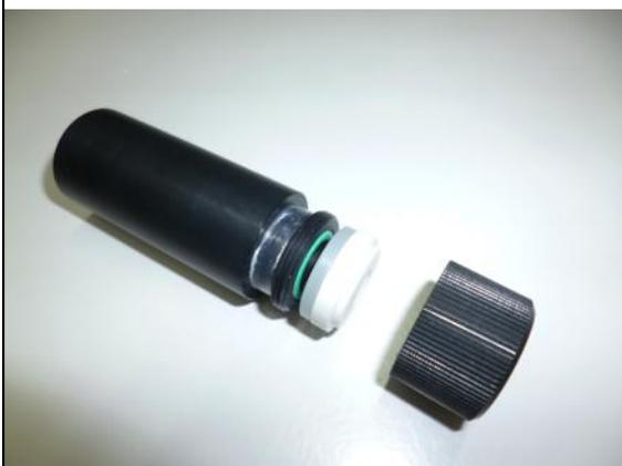
Bild 7+8: Messkammer mit Membran und Dichtungen
