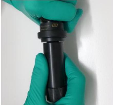
Bild 4+5: Demontage der Messkammer
