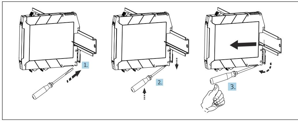
图 8 拆除 DIN 导轨盘装型变送器
