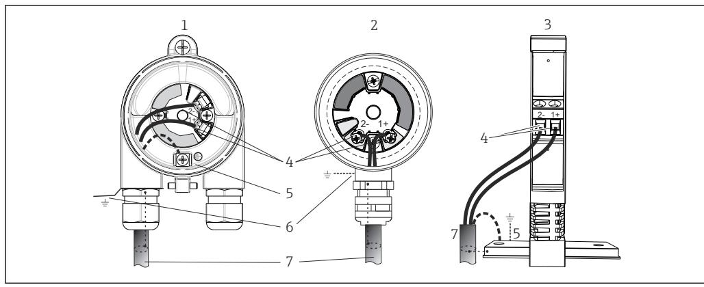
图 12 连接信号电缆和供电电缆
