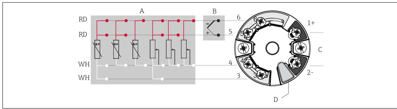
图 9 模块化变送器的接线端子分配
