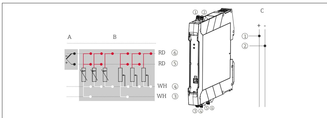
图 10 DIN 导轨型变送器的接线端子分配示意图
