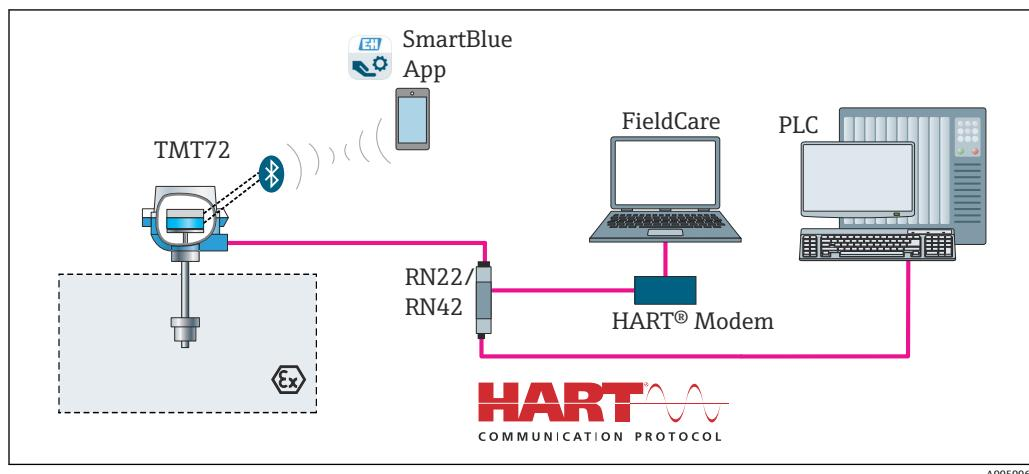
图 15 通过 HART®通信操作变送器
