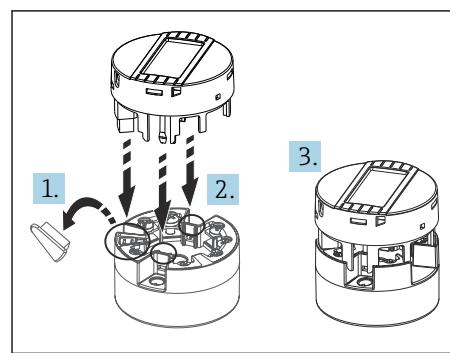
图 16 将显示单元安装在变送器上
