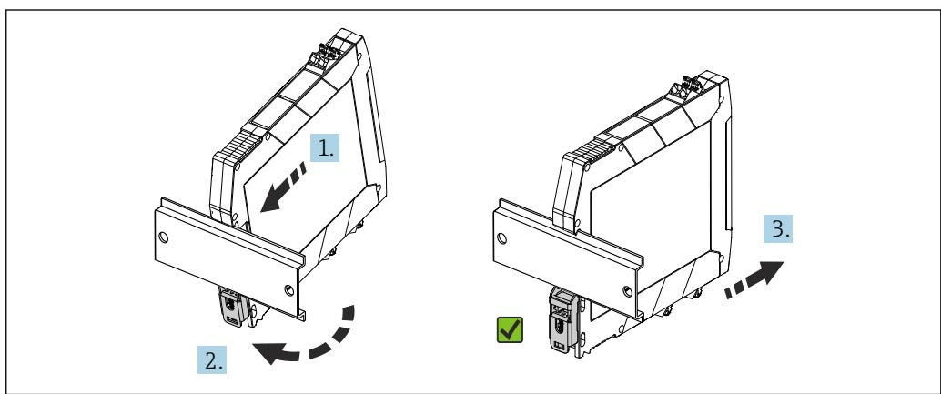
图 7 安装 DIN 导轨盘装型变送器
