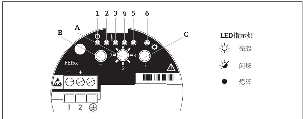
绿色 LED 指示灯 1 (可以工作)、红色 LED 指示灯 3 (故障)、黄色 LED 指示灯 6 (\* 开关状态)
